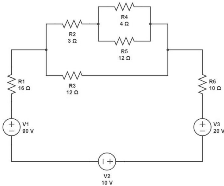
Assinale a alternativa que apresenta corretamente a corrente no resistor R6 em ampères e a potência total consumida pelos resistores R2, R3, R4 e R5 em watts.
