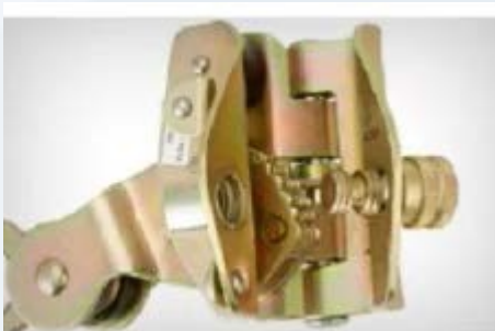
1- Abaixar a trava e desenroscar o parafuso e abrir puxando lateralmente
