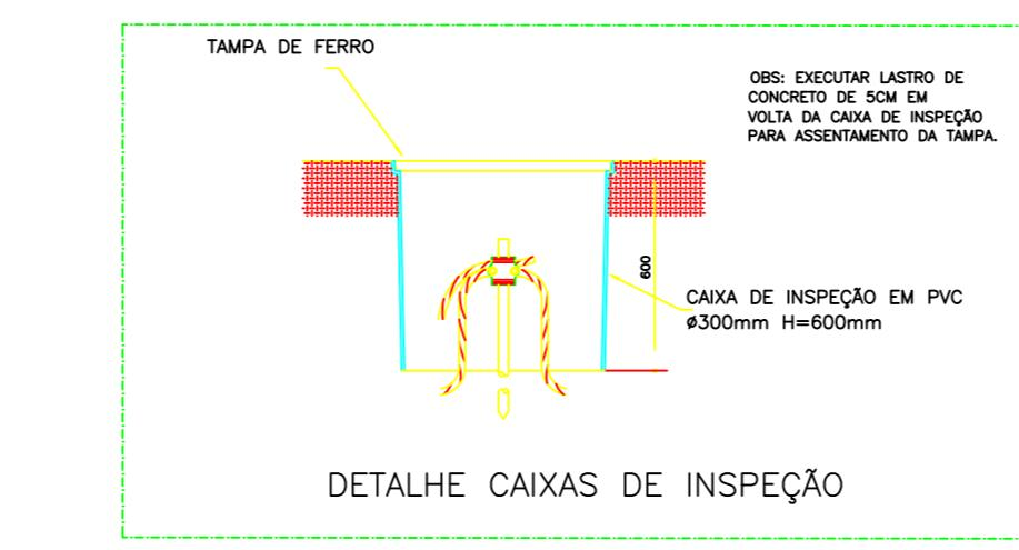
DETALHE CAIXA DE INSPEÇÃO DE ATERRAMENTO
