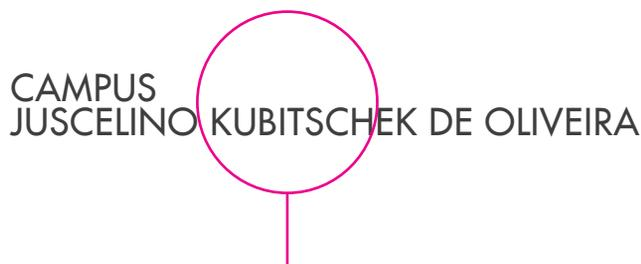
Letras recortadas a laser em chapa metálica de 2mm de espessura. Fundo anticorrosivo afixadas por pinos chumbados na parede de alvenaria.
