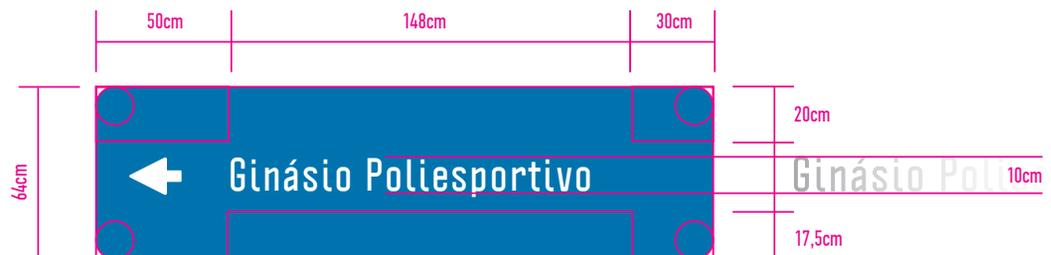
As placas de identificação de ruas funcionam, normalmente, combinadas em pares, afixadas com ângulo de 90° entre si, em um poste de **2,7m de altura**. Devido à menor altura, podem ser sujeitas a vandalismo, além da exposição natural ao sol e à chuva. Por isso, as placas de aço galvanizado, de 18mm, trazem laminação com pintura eletrostática e impressão direta em policromia (CMYK), para evitar que as letras sejam descoladas.
