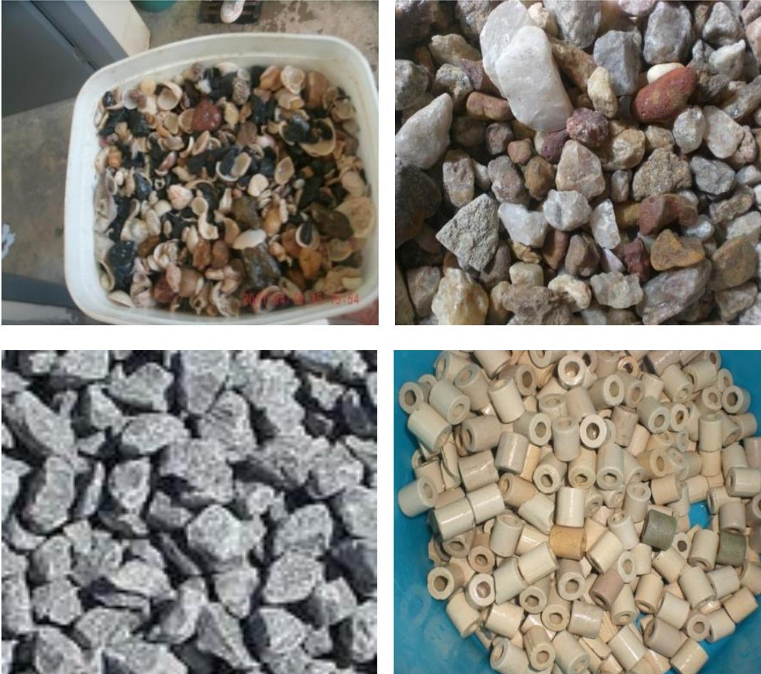
**Figura 3-** Tipos de substratos do biofiltro
